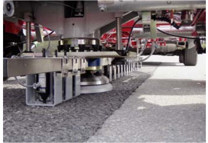
3 | Appareil de mesure de portance HWD. 3 | Tragfähigkeitsmessgerät HWD.
